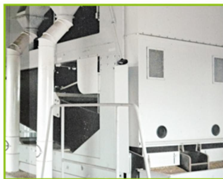
На выходе с нижнего решетного корпуса организован аспирационный канал окончательной очистки зерна. Из зернового слоя через проницаемую поверхность восходящим потоком воздуха уносятся легкие примеси, которые отделяются от воздуха во второй осадительной камере и шнеком выводятся из сепаратора.
