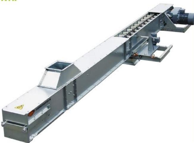
Верхний конвейер, производительность которого полностью согласована с производительностью соответствующей ковшовой нории.
