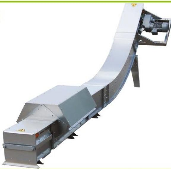
Приемный конвейер SKANDIA ELEVATOR обычно является первым звеном в системе и управляет производительностью последующей транспортной линии. Приемные конвейеры по мощности адаптированы для транспортирования материала из загрузочного приемника в норию SKANDIA ELEVATOR. Приемная секция саморегулирующаяся, что предотвращает переполнение и перегрузку транспортера с последующей остановкой. Он может оканчиваться наклоном 15°, 30° или 45°.
